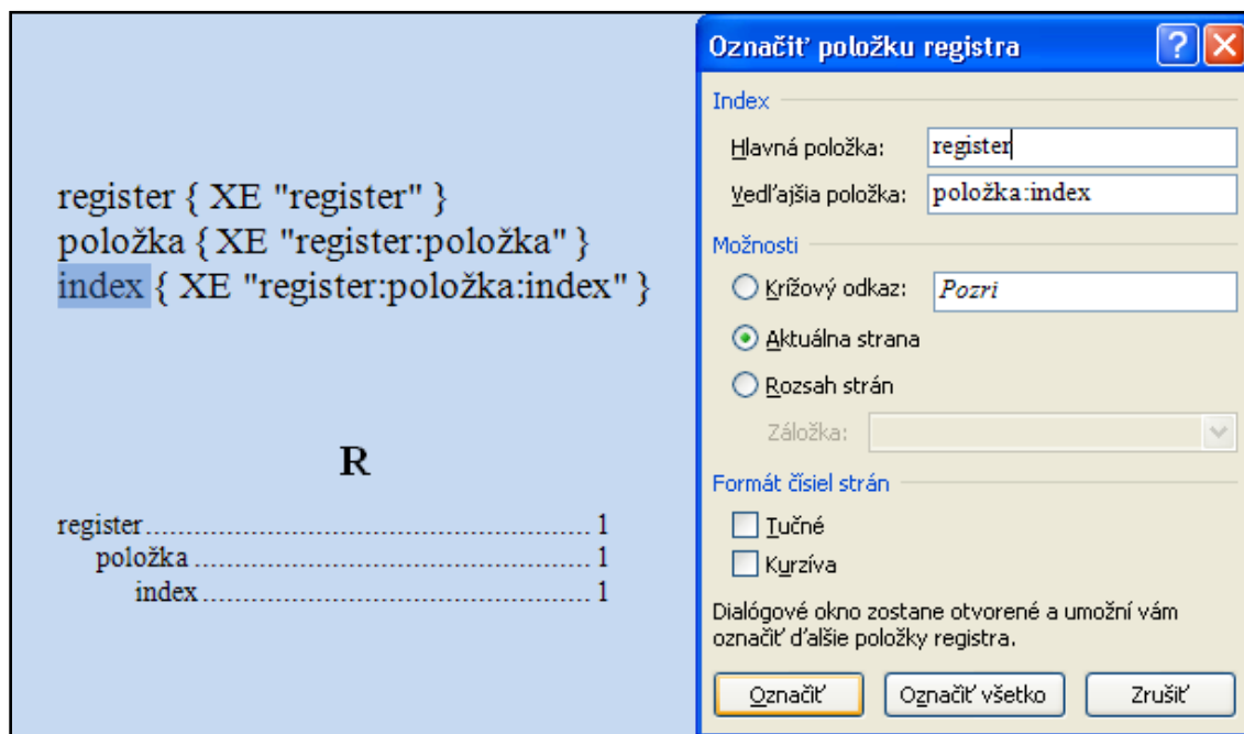
Obr. 7.15. Príklad trojúrovňového registra, so znením polí a oknom Označiť položku registra vyplnenú pre označenie položky tretej úrovne
