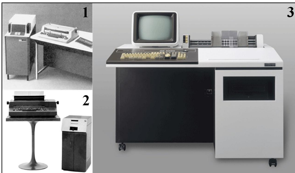
Obr. 1.1. Prvé textové procesory vo forme špecializovaných systémov: 1 – IBM MT-ST (Magnetic Type Selectric Typewriter – rok:1964), 2 – IBM-Mag Card 1 (rok:1969), 3 – Toshiba JW-10 (rok:1978)
